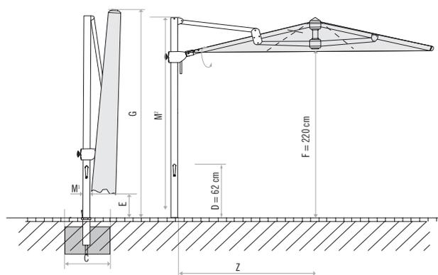
Looser Deckbelag max. 10 cm, Betondecke min. 30 cm (Frosttiefe beachten), Wasserabfluss.
